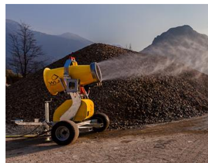
Figura 13 - Cannoni nebulizzatori per mitigazione polveri
