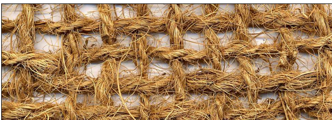
Figura 2.4 Biorete biodegradabile in fibra di cocco al 100% peso 700 gr/mq.
